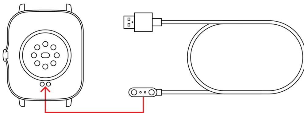
**Nota:** No tenga el cable del cargador conectado a corriente y los imanes contactando una superficie metálica. Provocará calentamiento y daños en el cargador.
